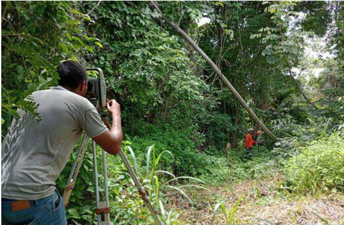
Levantamento por irradiação com estação total.
