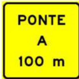
Figura 5 – Placa com informações complementares (Manual Brasileiro de Sinalização de Trânsito, VOLUME II – Sinalização Vertical de Advertência, 2022)
