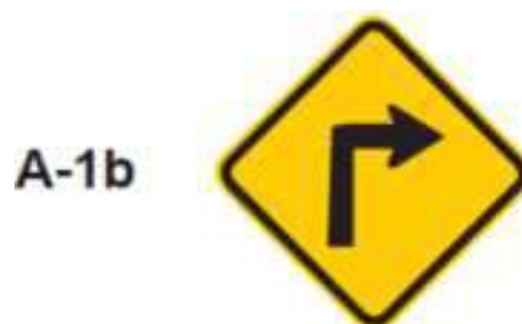
Figura 2 – Curva acentuada à direita (Manual Brasileiro de Sinalização de Trânsito, VOLUME II – Sinalização Vertical de Advertência, 2022)
