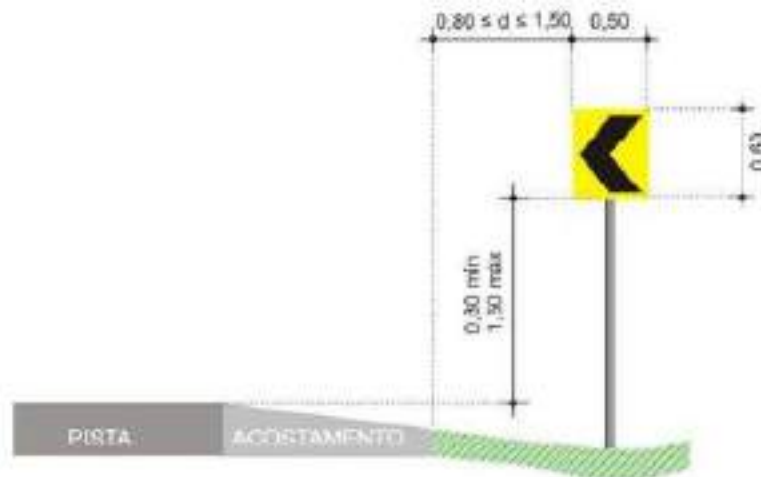
Figura 7 - Marcador de alinhamento (Manual Brasileiro de Sinalização de Trânsito, VOLUME VI – Dispositivos Auxiliares, 2022)
