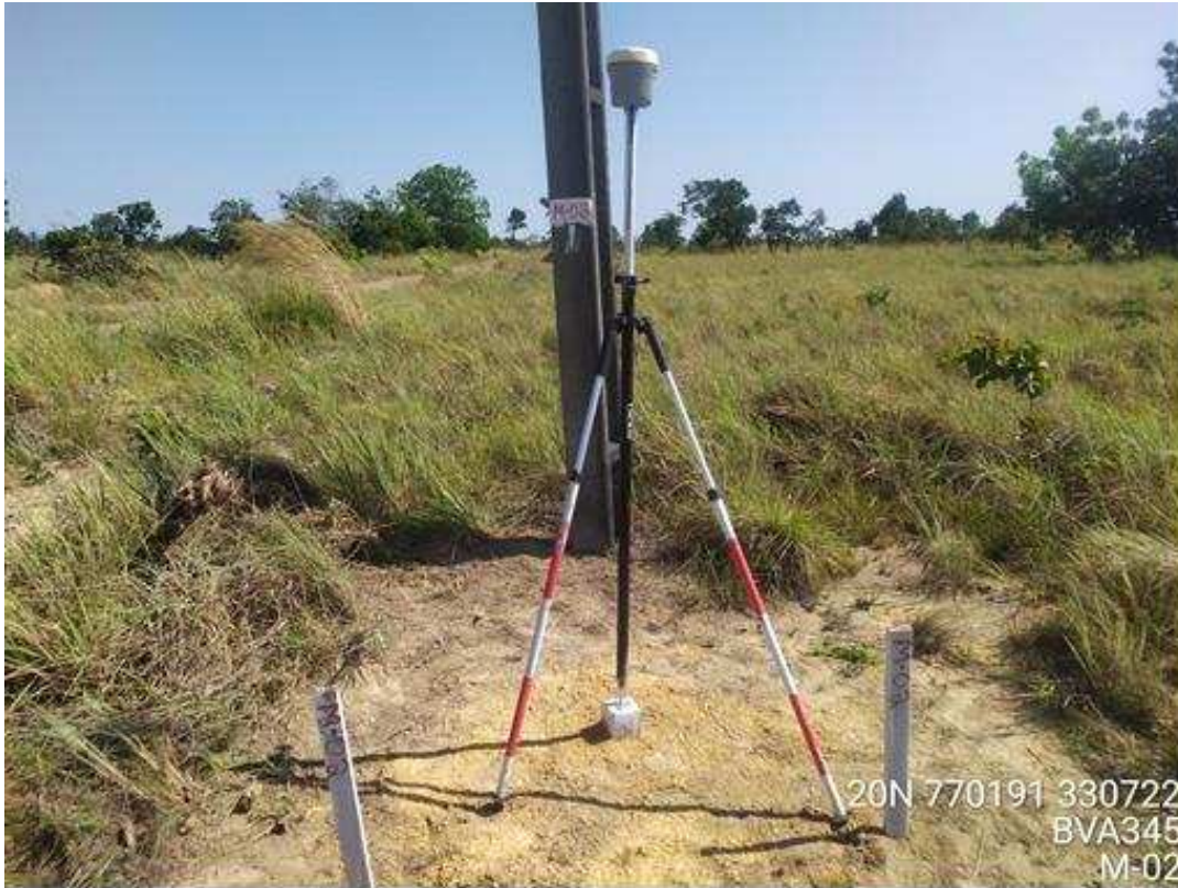
Rastreamento de dados GNSS para Pós Processamento Relativo Estático Rápido.
