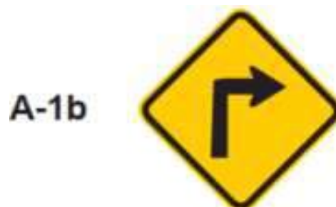
Figura 2 – Curva acentuada à direita (Manual Brasileiro de Sinalização de Trânsito, VOLUME II – Sinalização Vertical de Advertência, 2022)
